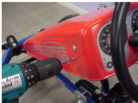
1. Boor een klein gaatje in de frontspoiler
