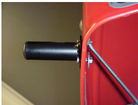
2. Bevestig de bijgeleverde stang aan de frontspoiler
